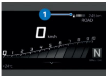
可达里程 **1** 表示剩余燃油还可以行驶的里程。根据平均油耗和燃油量进行计算。
