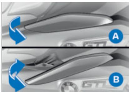
**A** 导流板关闭：较高的防风和天气保护，最佳骑行舒适度。
