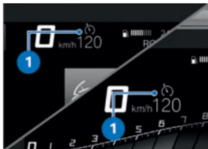
自动巡航控制系统的图标 **1** 将在视图 Pure Ride 和上部状态栏中显示。
