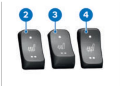
乘客座可以分为两档加热。第二加热档用于快速加热座椅，接着应切换回第一档。
