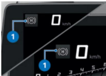
起步辅助的图标 **1** 将显示在上部状态栏和视图 Pure Ride 中。
