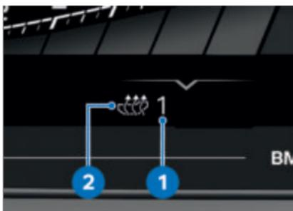
选择的加热档 **1** 和座椅加热功能图标 **2** 将显示在显示器上。
