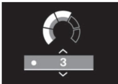
骑手座可以分五档加热。第五加热档用于快速加热座椅，接着应切换回较低档位之一。
