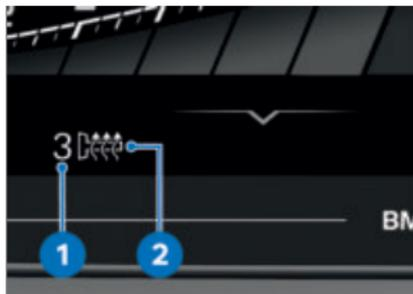
选择的加热档 **1** 和可加热式握把图标 **2** 将显示在显示器上。
