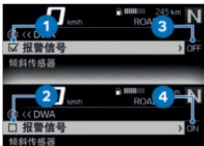
一些菜单项前面有小方框。小方框显示功能是否接通或关闭。菜单项后面的操作图标形象的说明，通过短促点击 Multi-Controller 可向右切换。
